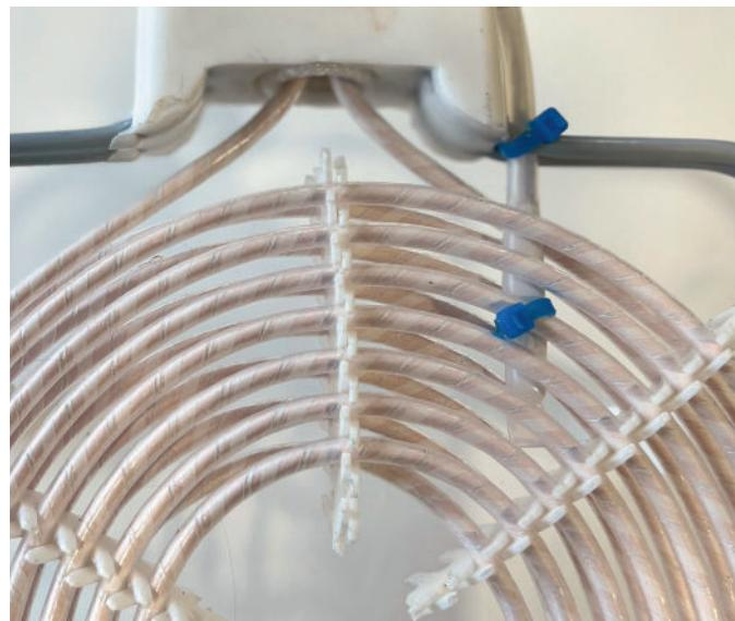
La sonde est montée le long de la partie non chauffante du thermoplongeur (câble N) avec des colliers en PP (polypropylène). La partie sensible de la sonde est insérée entre les spires chauffantes et maintenue à l'aide de 2 colliers en ETFE.
